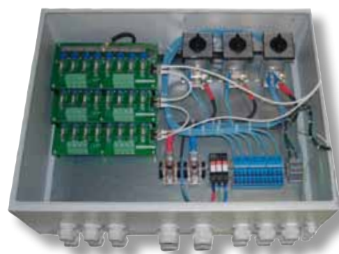
Vista detallada de la platina del controlador en el lado interior de la puerta de la carcasa
