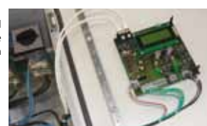
Vista detallada de la platina del controlador en el lado interior de la puerta de la carcasa
