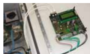
Vista dettagliata della scheda controller sul lato interno dello sportello dell'involucro
